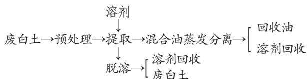
废白土经预处理, 主要为调节 pH 值、预热、制粒等, 然后加入溶剂(6 号溶剂油)浸提, 浸提方法分为浸泡和喷淋两种, 温度 50℃~55℃, 分离后得到溶剂混合油, 溶剂经蒸发得回收油。经浸出后废白土含油 5% 以下。含溶剂废白土脱溶后, 经再生处理仍可再次使用<sup>[2]</sup>。
